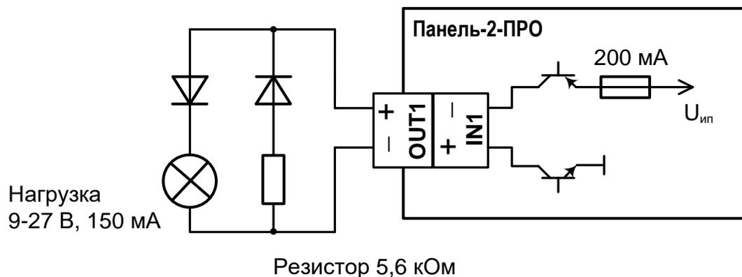
Схема подключения силового выхода типа "Открытый коллектор".
