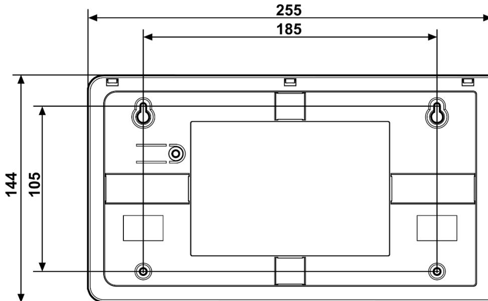
После навешивания крышки Панель-2-ПРО она закрепляется на стене путём ввёртывания одного, либо двух дополнительных шурупов.
