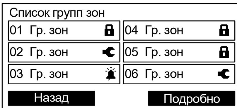
Для управления выделенной группой зон следует нажать одну из клавиш , , **0 x**, **5** и предъявить номер и код пользователя.
