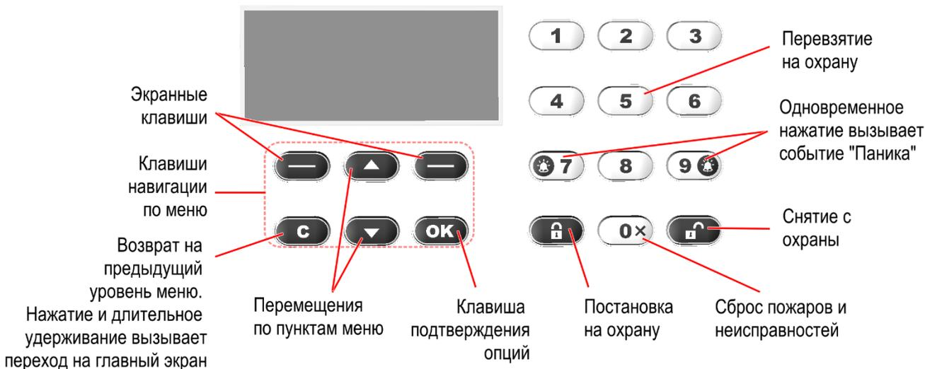
Специализированные клавиши  $\langle \text{замок} \rangle$  (взять) и  $\langle \text{замок} \rangle$  (снять) предназначены для постановки на охрану и снятия с охраны соответственно. С помощью клавиши  $\langle 0 \times \rangle$  выполняется сброс пожарных тревог и неисправностей. С помощью клавиши  $\langle 5 \rangle$  выполняется "Перевзятие" зон на охрану.
