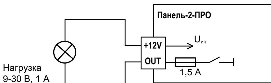
Схема подключения силового выхода типа "Открытый коллектор" с внешним источником питания постоянного или переменного тока.
