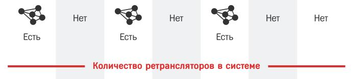
Если система не поддерживает ретрансляторы, то связь между контроллерами нужно будет обеспечивать по проводному интерфейсу. Разумеется, в таком случае частично теряются преимущества использования беспроводной системы.
