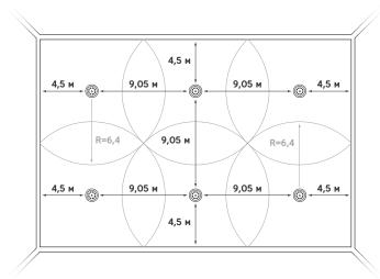
Расстояния между извещателями и радиусы действия приведены для дымовых извещателей Аврора-Д-ПРО и помещений с высотой потолков до 3,5 м.
