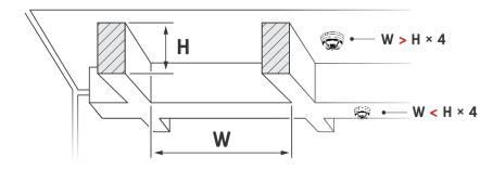
При определённых условиях извещатели можно закрепить на нижней плоскости балки.
