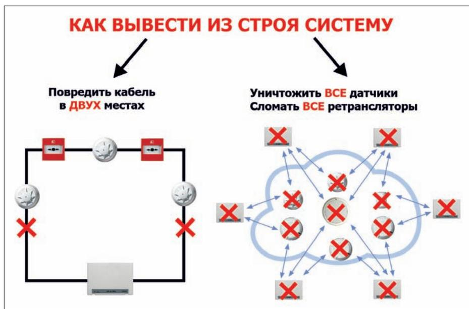
Рис. 2. Сравнение проводных и радиоканальных систем по количеству связей между извещателем и ретрансляторами
