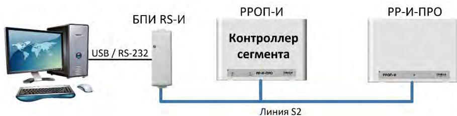
В случае, если в качестве КСГ используется РР-И-ПРО, то к линии S2 сегмента возможно подключать устройства индикации и управления, а также коммуникационные устройства из состава ИСБ.
