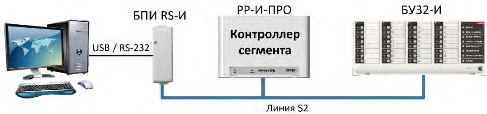
В случае, если к линии S2 не подключаются устройства, то конфигурирование возможно выполнять с использованием интерфейса USB у РР-И-ПРО.
