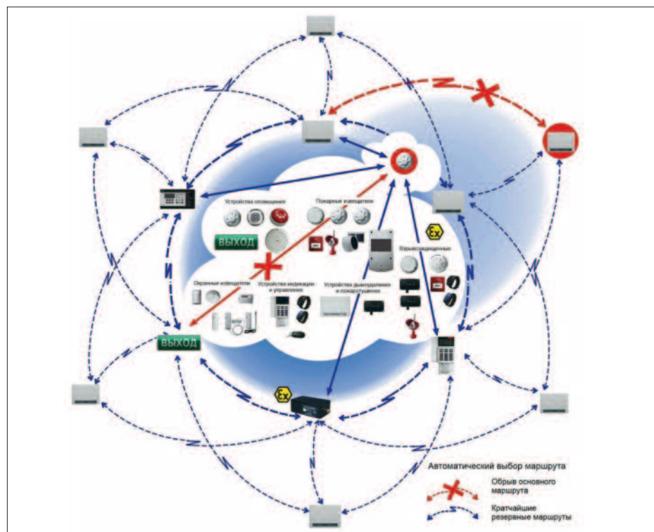
Рис. 1. Схема глобального роуминга на примере беспроводной системы пожарной сигнализации, оповещения и локализации
