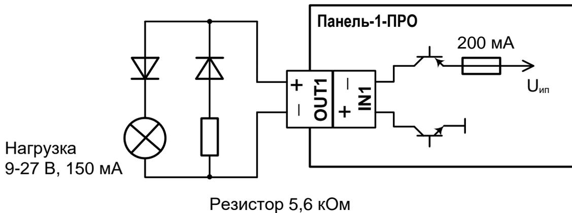
Схема подключения **силового выхода** типа "Открытый коллектор".
