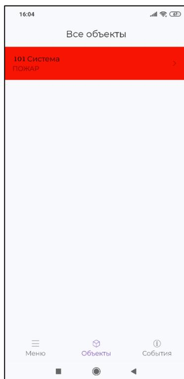
Если кликнуть по полю "Система", то отобразятся Сегменты системы. Клик по Сегменту приведет к отображению Разделов в этом Сегменте. Клик по Разделу приведет к отображению дочерних устройств в Разделе. Клик по Устройству отобразит протокол событий, связанных с этим устройством.
