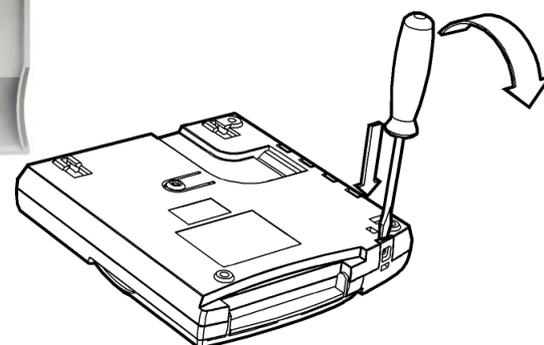
Для снятия крышки отсека подключений необходимо использовать отвёртку.
