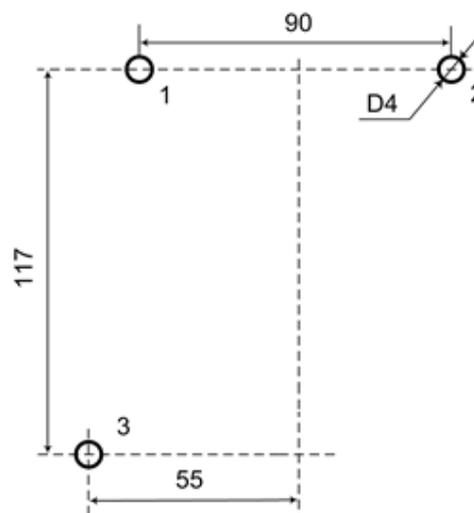
4. Вверните шурупы в отверстия 1 и 2 и навесьте на них контроллер
