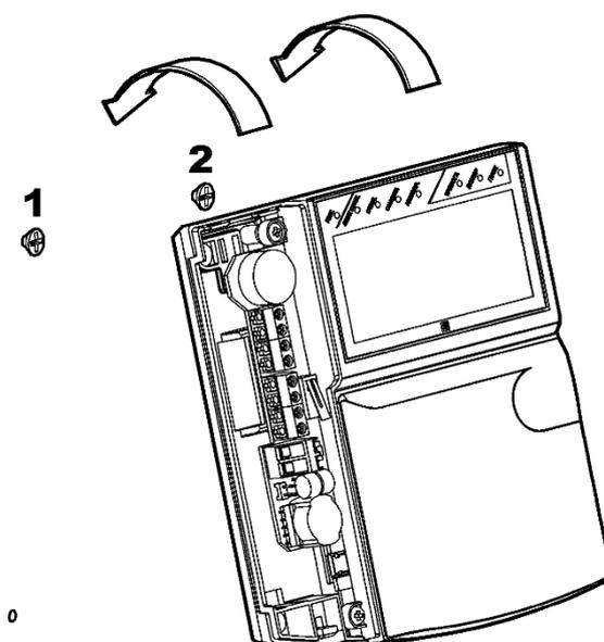
5. Пропустите соединительные провода через отверстия в основании корпуса
