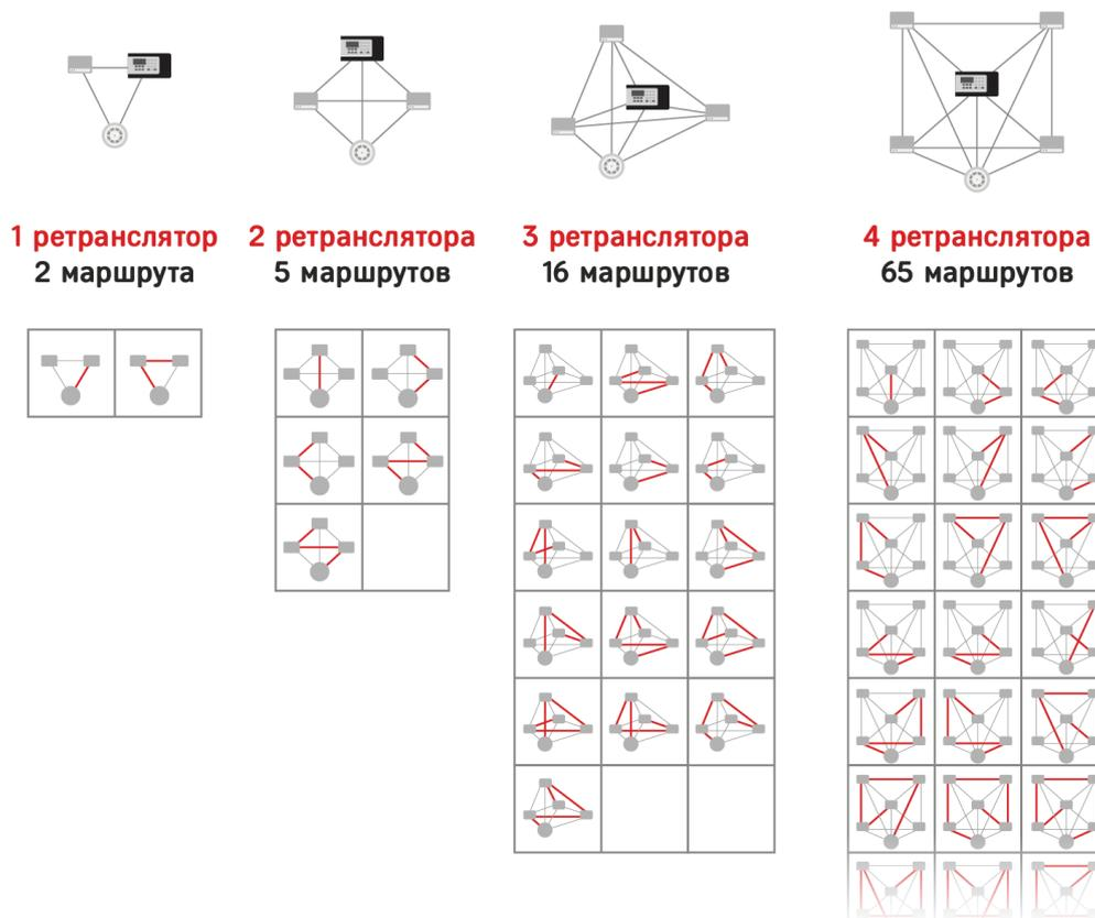
Рис. А.3 Иллюстрация количества потенциальных путей передачи сигнала при различных количествах РР в системе
