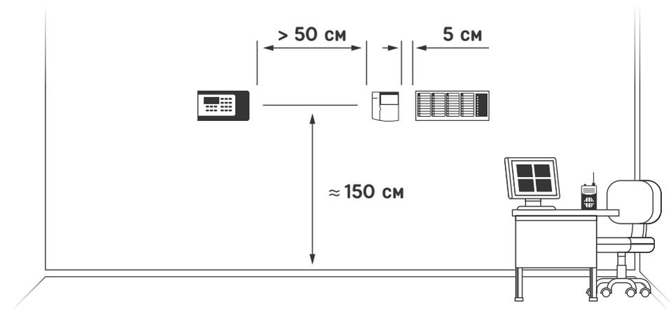
Блок индикации **БУ32-И**, пульта **ПС-И** и **Пульт-РР-ПРО** следует размещать на уровне 1,5 метра от пола, но не выше 1,8 метра.
