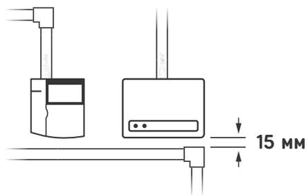
При монтаже кабель-канала, отступайте от корпусов приборов небольшое расстояние снизу, иначе будет неудобно открывать на них крышки.
