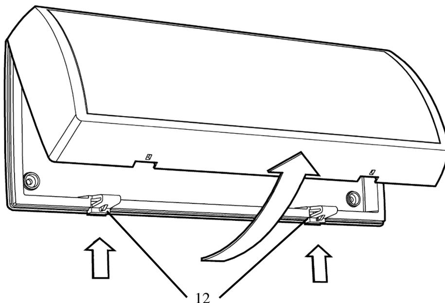
Изделие поставляется с установленным экраном с надписью "ВЫХОД". Потребитель имеет возможность установить вместо экрана вкладыши с другими надписями.
