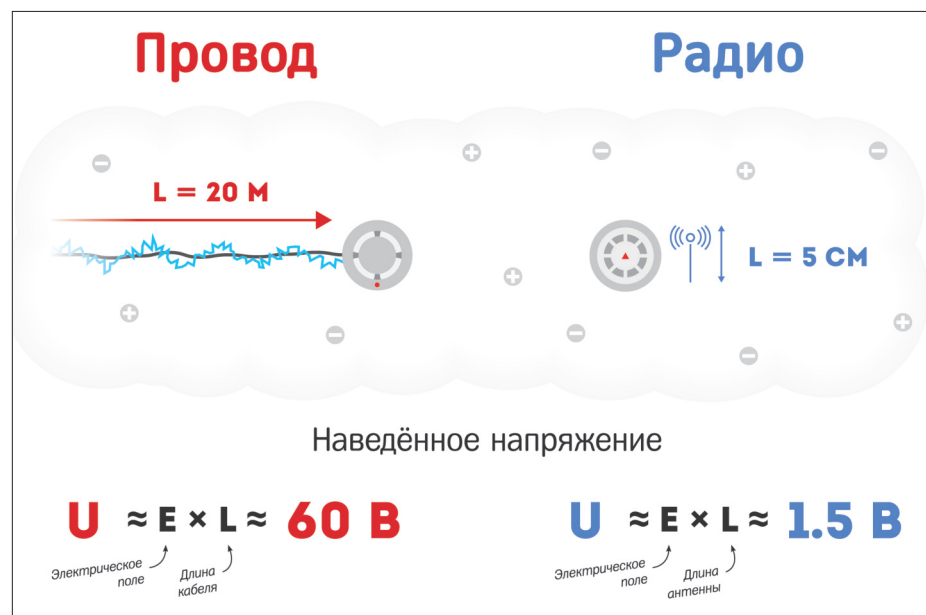
Рис. 2. Кабельные линии – антенны для электромагнитных наводок
