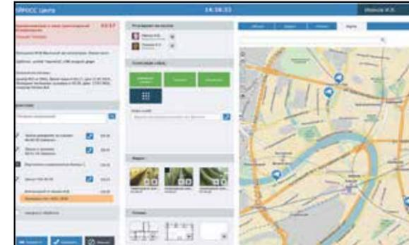
Отображение на планах и картах источника события, элементов систем безопасности.
