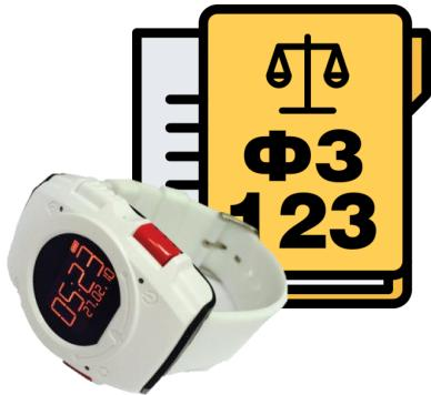
12. «...Здания медицинских организаций, учреждений [...] должны быть дополнительно оборудованы системами оповещения о пожаре, в том числе с использованием **персональных устройств** со световым, звуковым и с вибрационным сигналами оповещения.
