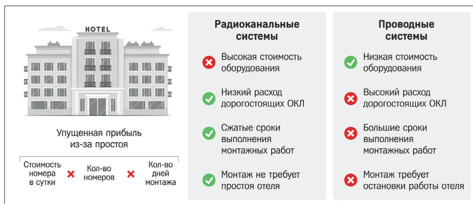
Рис. 2. Сравнение радиоканальных и проводных систем для отелей
