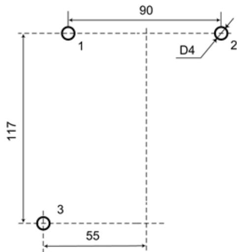
4. Вверните шурупы в отверстия 1 и 2 и навесьте на них контроллер
