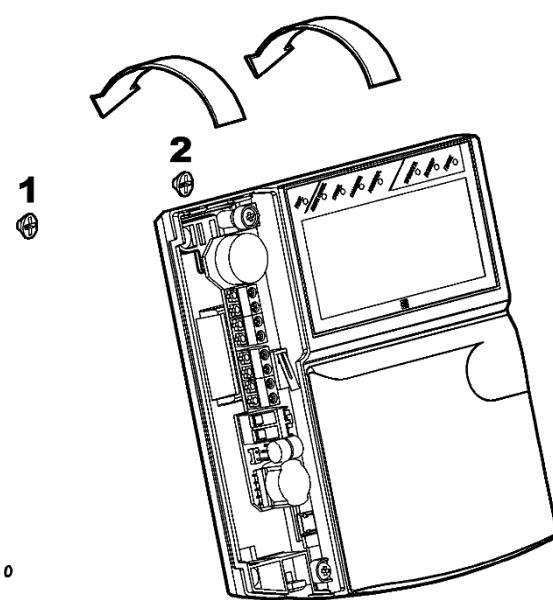
5. Пропустите соединительные провода через отверстия в основании корпуса
