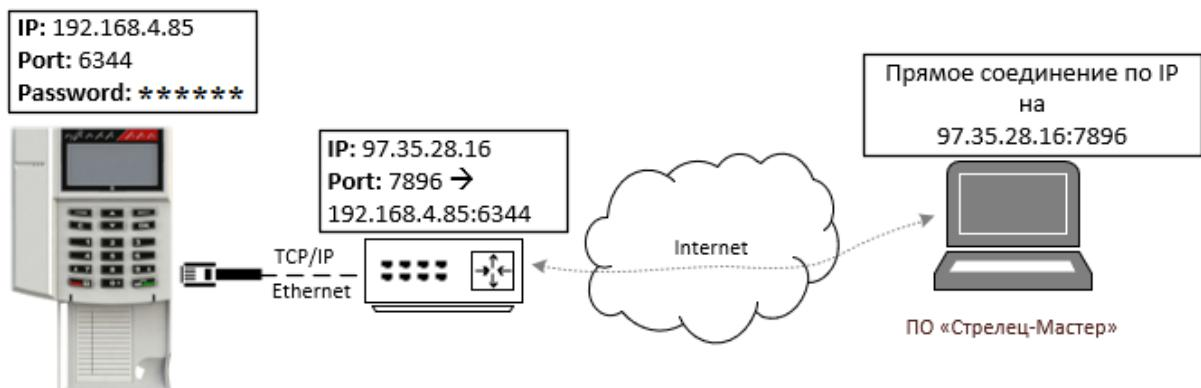
Панель необходимо подключить в локальную сеть (к маршрутизатору) с помощью UTP-кабеля.
