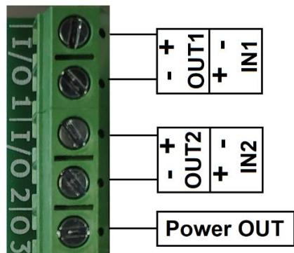
Схема подключения ко входам **охранных, тревожных или технологических** извещателей с выходом типа "сухой контакт":
