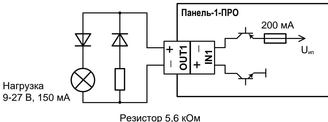
Схема подключения **силового выхода** типа "Открытый коллектор".
