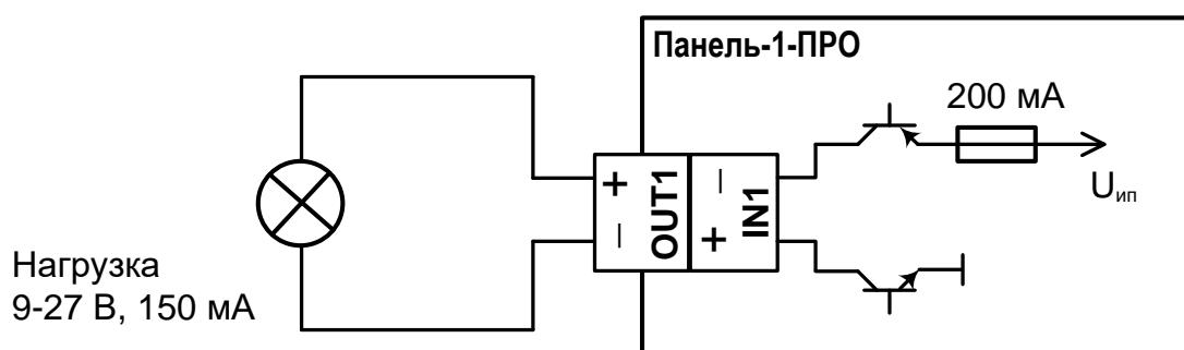
Схема подключения выходов типа "Открытый коллектор с контролем целостности цепи до нагрузки".
