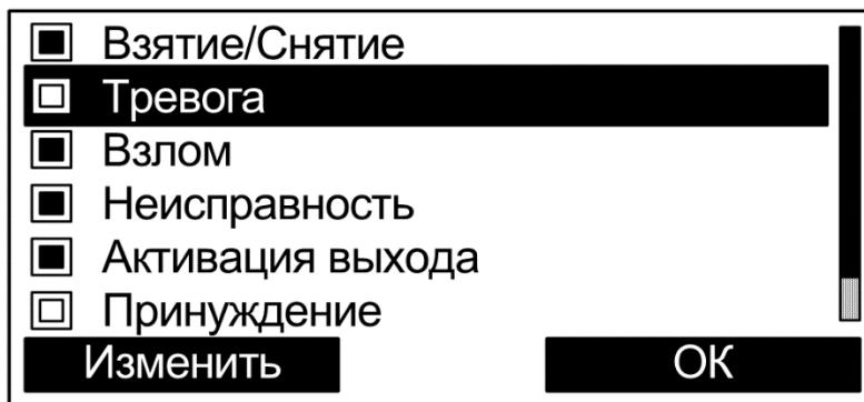
События, которые должны отображаться при просмотре протокола, отмечаются закрашенным квадратом. Для выбора опции фильтра следует выделить строку с событием и нажать экранную клавишу **<Изменить>**.
