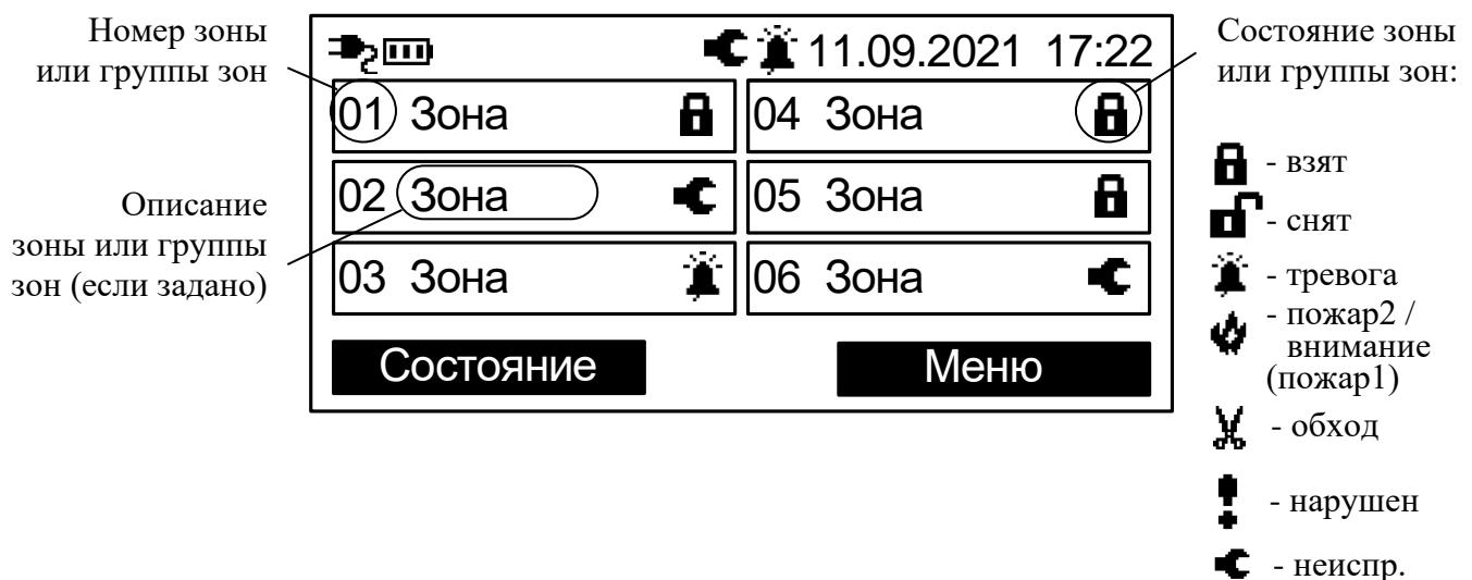
Экранные клавиши на главном экране имеют обозначения **«Меню»** и **«Состояние»**. При нажатии экранной клавиши **«Меню»** отображается меню контроллера.
