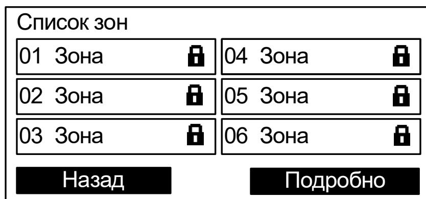
При нажатии кнопки **<Подробно>** открывается меню состава выбранной зоны. В нем отображаются адреса, входящие в состав этой зоны, и их состояния.
