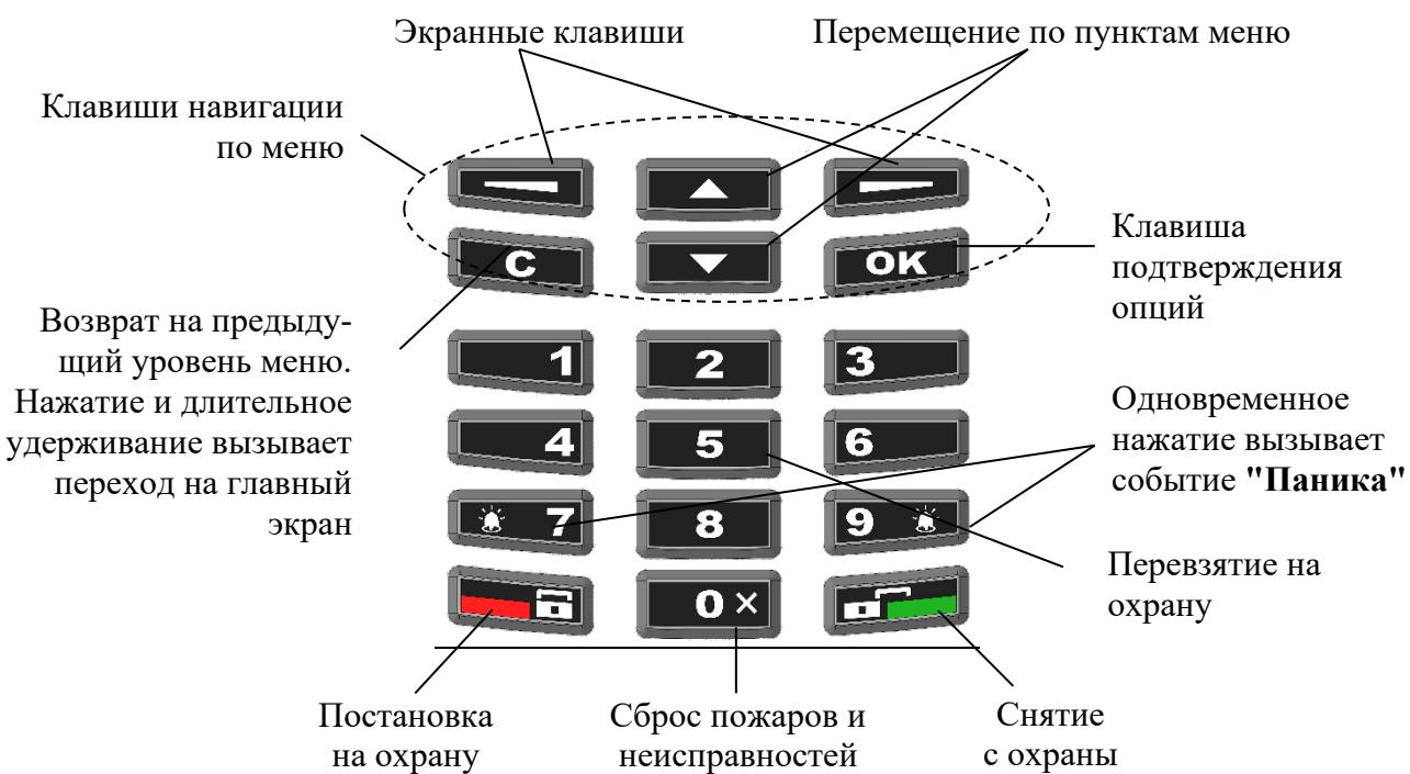
Специализированные клавиши  $\leftarrow\rightarrow$  (взять) и  $\leftarrow\rightarrow$  (снять) предназначены для постановки на охрану и снятия с охраны соответственно. С помощью клавиши **0 x** выполняется сброс пожарных тревог и неисправностей. С помощью клавиши **5** выполняется "Перевзятие" зон на охрану.
