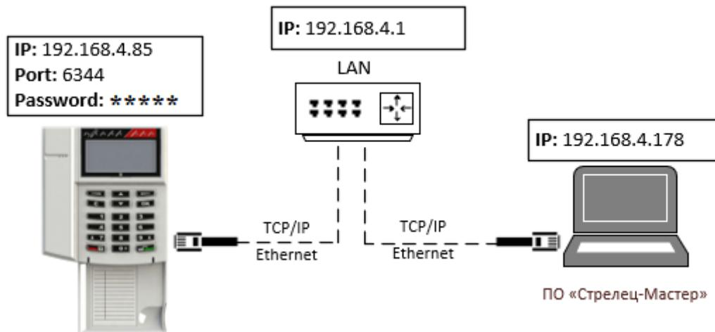
Панель необходимо подключить в локальную сеть (к маршрутизатору) с помощью UTP-кабеля.
