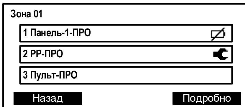
При нажатии кнопки **<Подробно>** открывается подробное состояние адреса (в зависимости от типа устройства отображаемая информация может быть различной).
