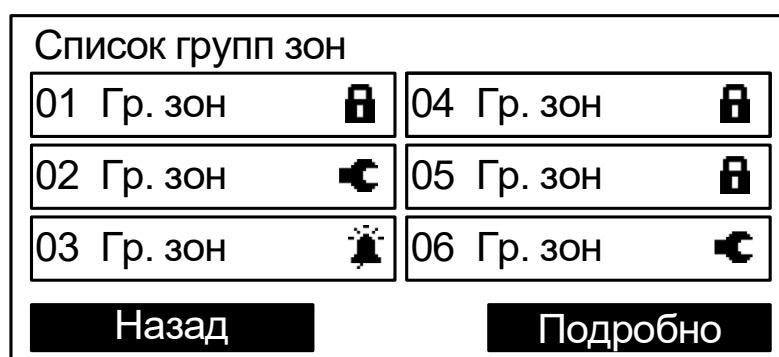
Для управления выделенной группой зон следует нажать одну из клавиш **<1>**, **<2>**, **<0 x>**, **<5>** и предъявить номер и код пользователя.
