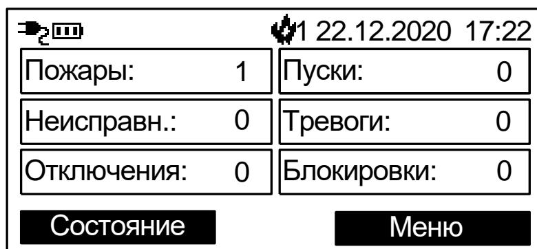
Если выбрать для отображения зоны/группы зон на главном экране, то для "Системы пожарной безопасности" и для "Интегрированной системы" на главном экране отображаются текущее время, пиктограммы состояния, а также назначенные при программировании зоны или группы зон (до 6 шт.) для быстрого доступа.
