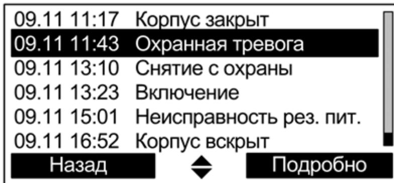
При нажатии экранной клавиши **«Подробно»** открывается окно с детальным описанием события, включающим дату, время и место события, а также дополнительную информацию в зависимости от типа события. Номера зоны и устройства сопровождаются текстовыми описаниями (при наличии).
