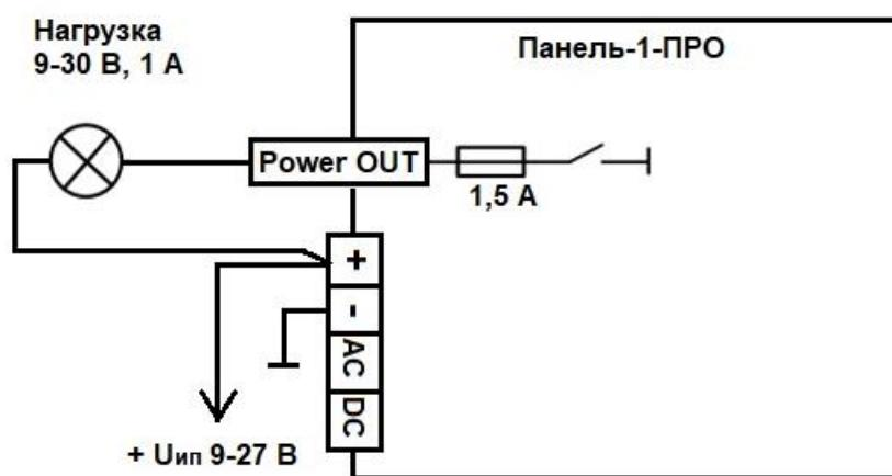
Схема подключения **силового выхода** типа "Открытый коллектор" с внешним источником питания постоянного или переменного тока.
