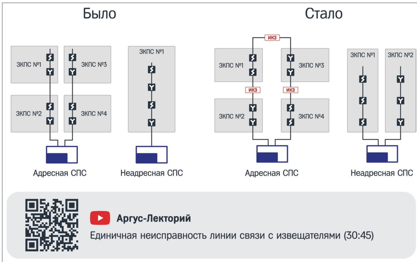
Рис. 2. Единичный отказ линии связи между ППКП и ИП не должен приводить к потере контроля более чем одной ЗКПС
