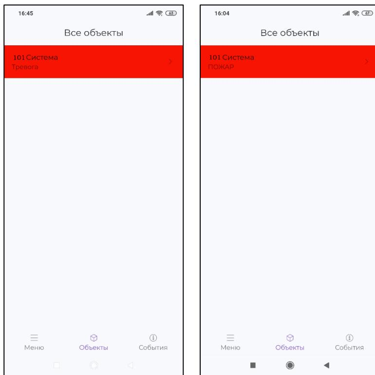
Если кликнуть по полю "Система", то отобразятся Сегменты системы. Клик по Сегменту приведет к отображению Разделов в этом Сегменте. Клик по Разделу приведет к отображению дочерних устройств в Разделе. Клик по Устройству отобразит протокол событий, связанных с этим устройством.
