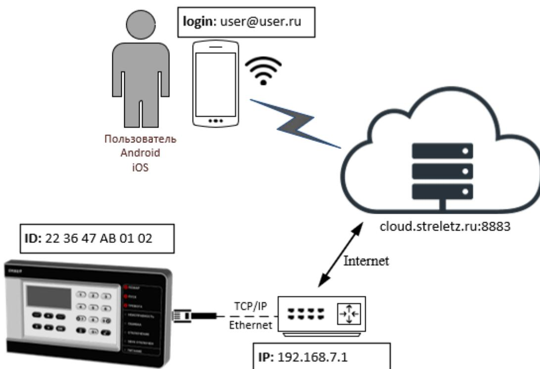
Если в оборудовании сети поддерживается протокол DHCP, то может быть использован режим "Получить IP-адрес автоматически".
