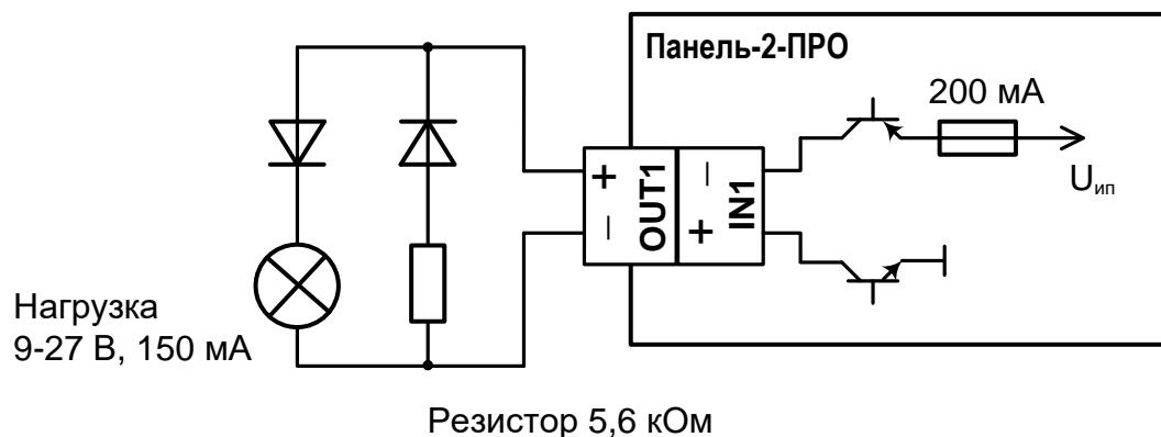
Схема подключения **силового выхода** типа "Открытый коллектор".
