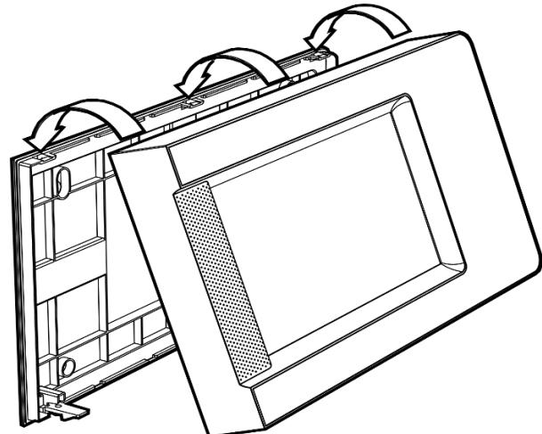
Зафиксировать защелки шурупами 3x10
