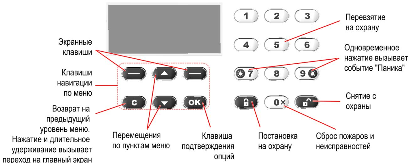
Специализированные клавиши <**🔒**> (взять) и <**🔓**> (снять) предназначены для постановки на охрану и снятия с охраны соответственно. С помощью клавиши <**ⓧ ×**> выполняется сброс пожарных тревог и неисправностей. С помощью клавиши <**5**> выполняется "Перевзятие" разделов на охрану.
