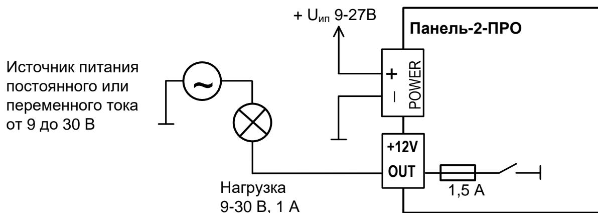
**Схема подключения выходов сигнального реле с внешним источником питания постоянного или переменного тока.**
