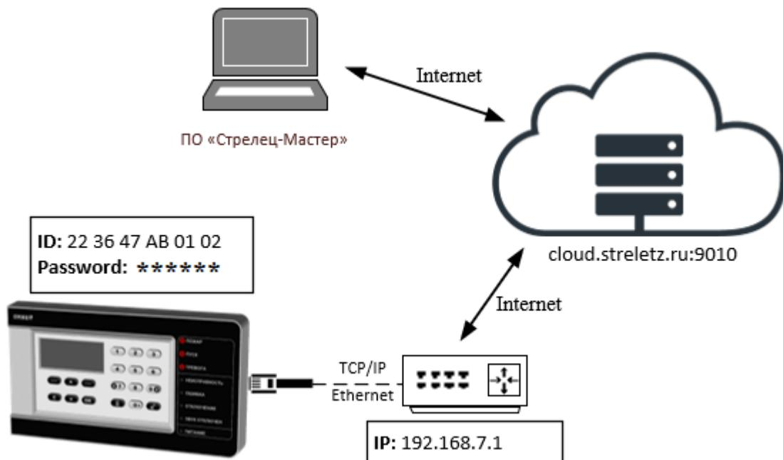
Если в оборудовании сети поддерживается протокол DHCP, то может быть использован режим "Получить IP-адрес автоматически".
