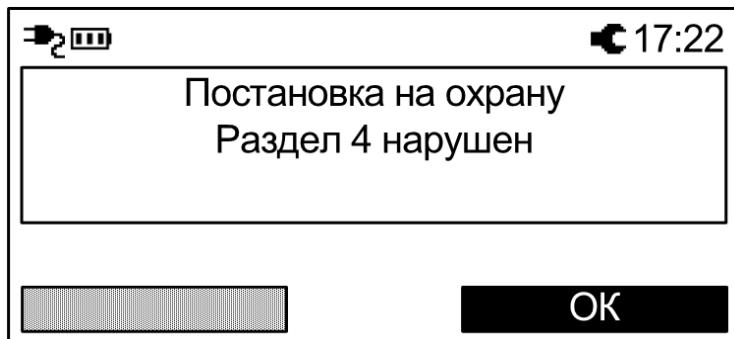
При постановке на охрану с обходом (отключением) на экране отобразится сообщение с номером и описанием отключенного извещателя (шлейфа) и в верхней части экрана будет индицироваться пиктограмма .
