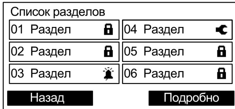
При нажатии кнопки **<Подробно>** открывается меню состава выбранного раздела. В нем отображаются адреса, входящие в состав этого раздела, и их состояния.
