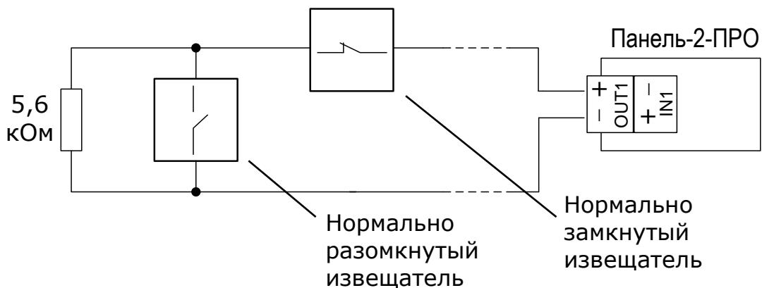
Схема подключения **нормально разомкнутых пожарных извещателей** с выходом типа "сухой контакт":
