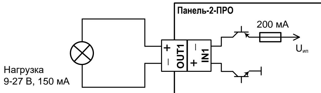
Схема подключения выходов типа "Открытый коллектор с контролем целостности цепи до нагрузки".
