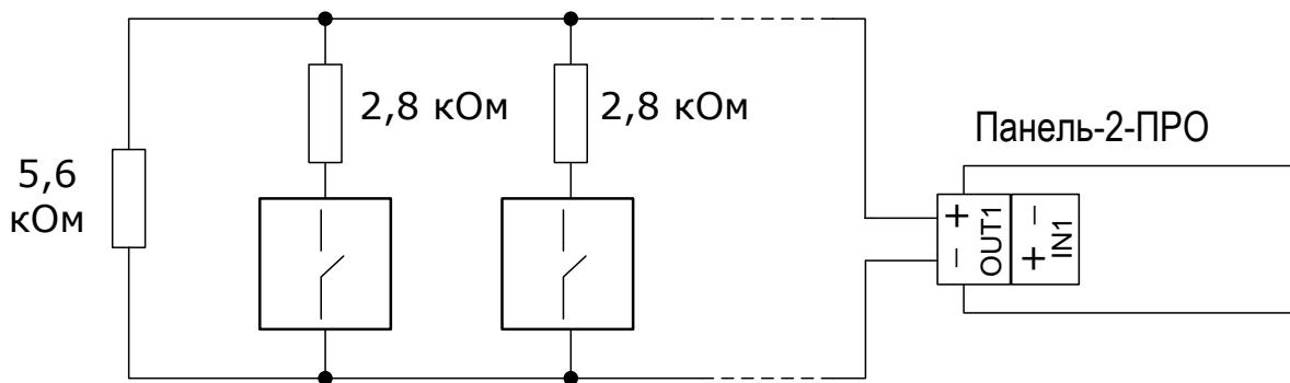
Подключение **нормально замкнутых пожарных извещателей** с выходом типа "сухой контакт":
