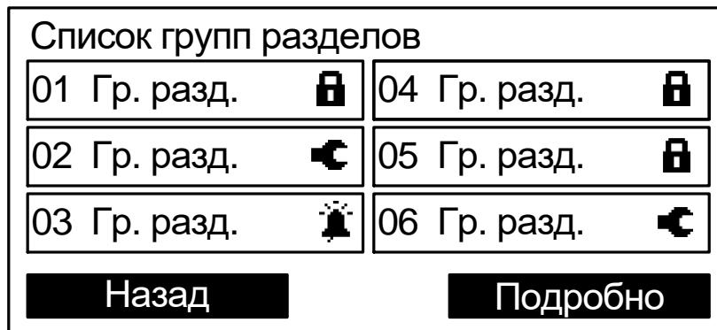
Для управления выделенной группой разделов следует нажать одну из клавиш **<LOCK>**, **<KEY>**, **<0 x>**, **<5>** и предъявить номер и код пользователя.
