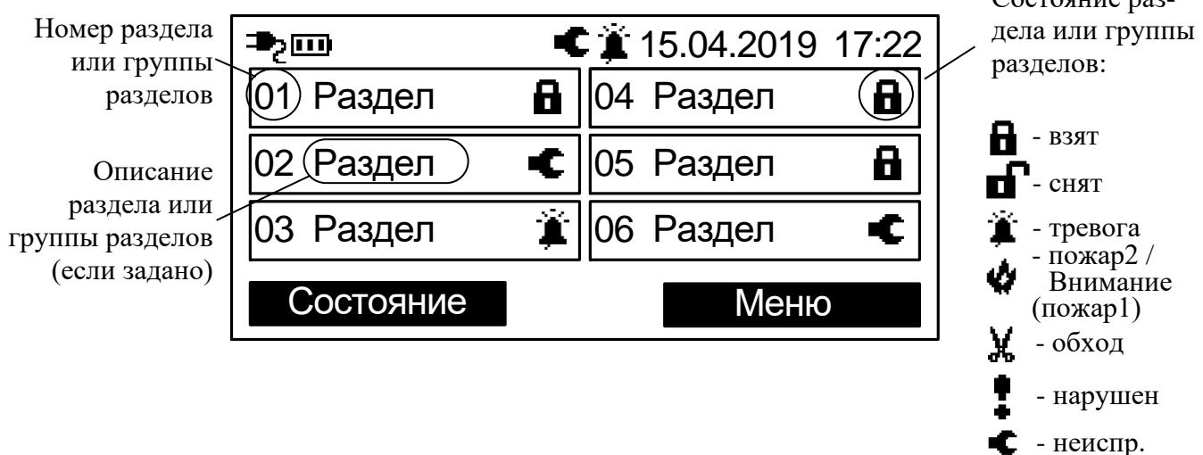
Экранные клавиши на главном экране – **«Меню»** и **«Состояние»**. При нажатии экранной клавиши **«Меню»** отображается меню контроллера.
