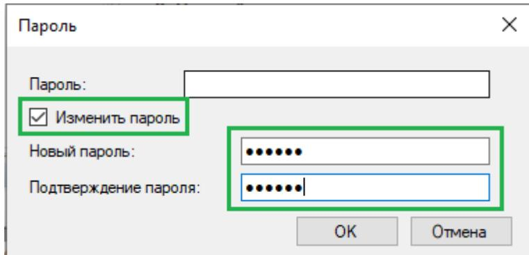
Вместо старого пароля можно либо ничего не вписывать, либо вписать новый пароль. Изменение пароля возможно только при подключении к ПК по USB!
