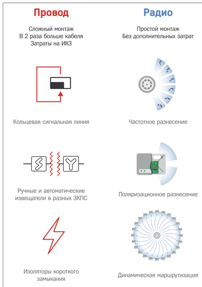
Рис. 2. Обеспечение устойчивости линий связи к единичной неисправности в проводных и беспроводных СПА
