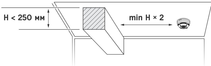
Если на потолке имеются инженерные конструкции, выступающие на 25 сантиметров и меньше, то расстояние от этой конструкции до извещателя должно быть не меньше её двойной высоты. Например, от квадратной балки со стороной 10 см нужно отступить 20 см.
