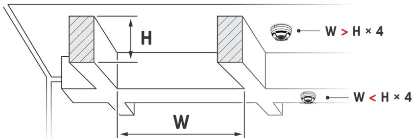
При определённых условиях извещатели можно закрепить на нижней плоскости балки.
