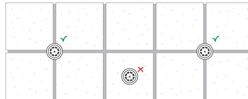
Извещатели серии Аврора нельзя устанавливать непосредственно на потолочную плитку, необходимо закреплять их на профиль, создающий каркас потолка.
