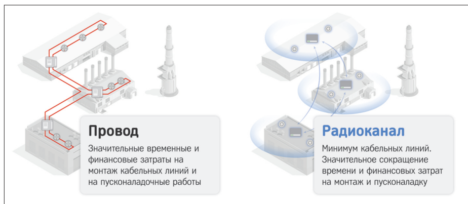
Рис. 2. Преимущества радиосистем при монтаже и пусконаладке
