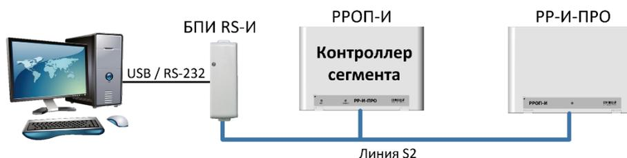
В случае, если в качестве КСГ используется РР-И-ПРО, то к линии S2 сегмента возможно подключать устройства индикации и управления, а также коммуникационные устройства из состава ИСБ.
