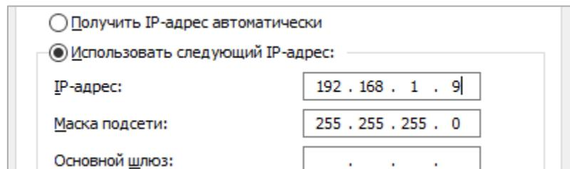
В "Настройка подключения" необходимо указать IP-адрес Панели, Порт подключения и Пароль (см. 5.6).
