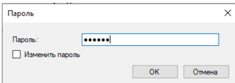
Если Панель новая или сброшена к заводским настройкам, в качестве пароля следует указать **пароль с этикетки** на приборе (см. 2.5).
