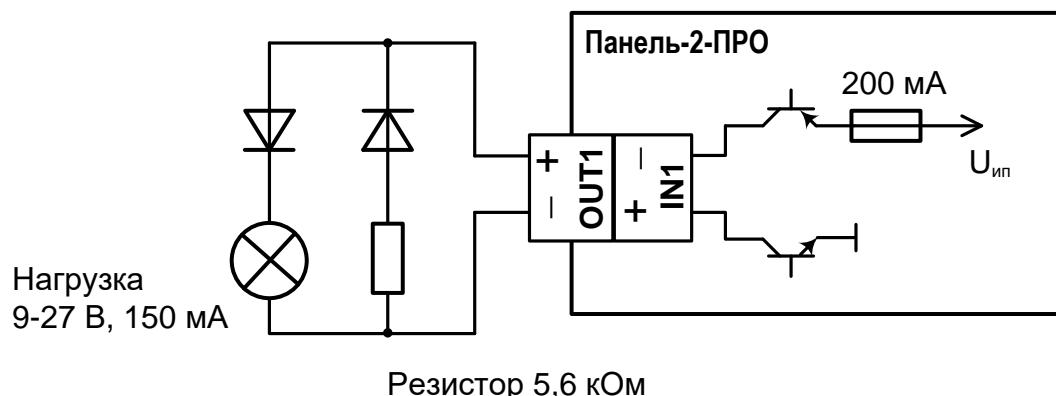
Схема подключения нескольких устройств к выходам типа «Открытый коллектор с контролем цепи до нагрузки»:
