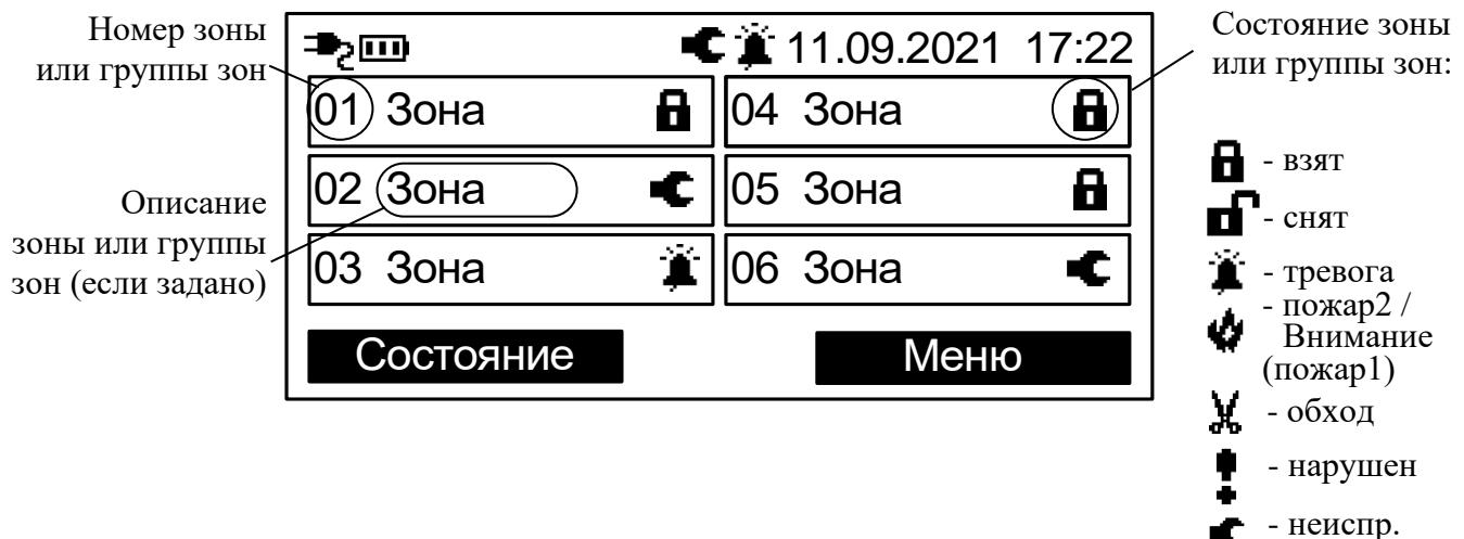
Экранные клавиши на главном экране – **«Меню»** и **«Состояние»**. При нажатии экранной клавиши **«Меню»** отображается меню контроллера.
