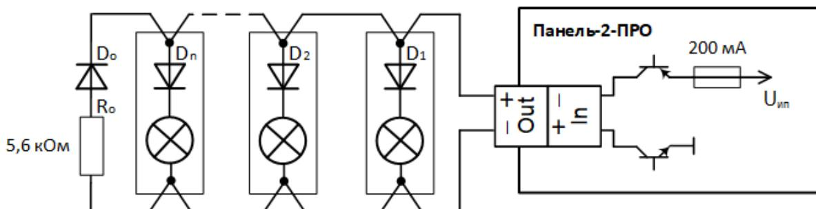
Оконечные диоды  $D_o$  и резистор  $R_o$  рекомендуется устанавливать в непосредственной близости от корпуса последнего устройства-нагрузки, а диоды  $D_1$ ,  $D_2$ , ...  $D_n$  устанавливать внутри корпуса устройства-нагрузки (для световых оповещателей установка  $D_1$ ,  $D_2$ , ...  $D_n$  не требуется).
