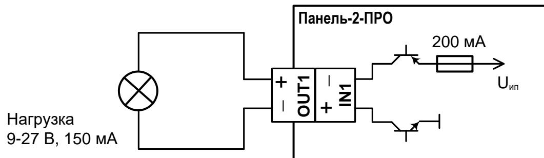
Схема подключения выходов типа "Открытый коллектор с контролем цепи до нагрузки".
