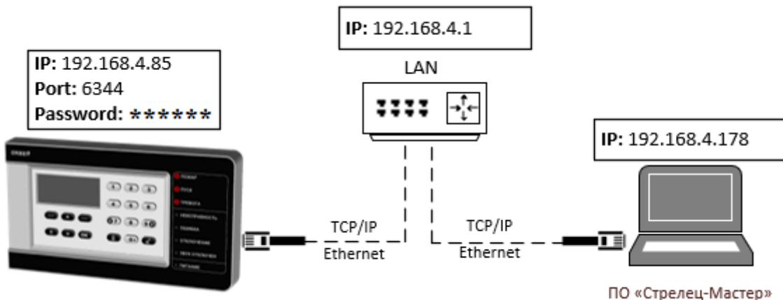
Панель необходимо подключить в локальную сеть (к маршрутизатору) с помощью UTP-кабеля.
