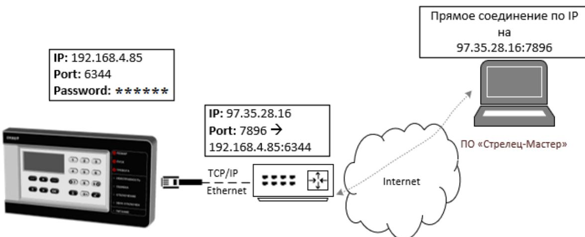
Панель необходимо подключить в локальную сеть (к маршрутизатору) с помощью UTP-кабеля.
