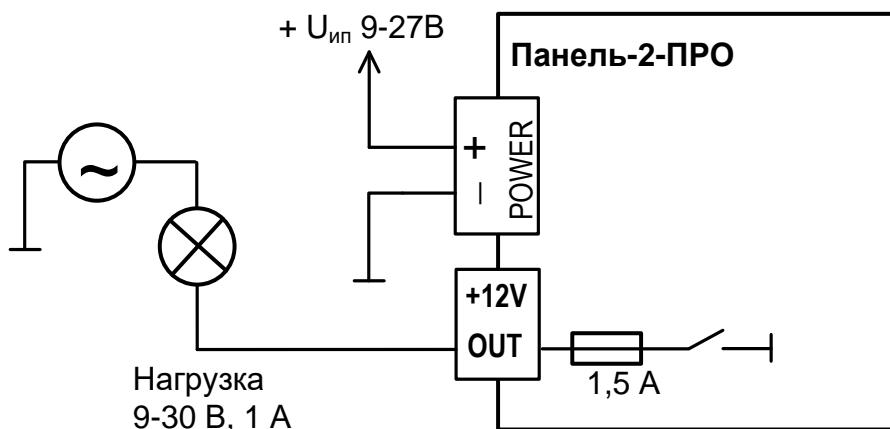
Схема подключения выходов сигнального реле с внешним источником питания постоянного или переменного тока.
