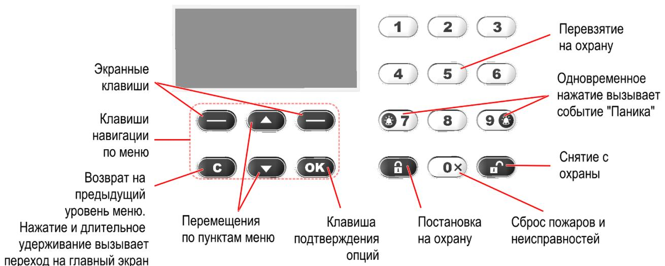
Специализированные клавиши **<🔒>** (взять) и **<🔓>** (снять) предназначены для постановки на охрану и снятия с охраны соответственно. С помощью клавиши **0 ×** выполняется сброс пожарных тревог и неисправностей. С помощью клавиши **5** выполняется "Перевзятие" зон на охрану.
