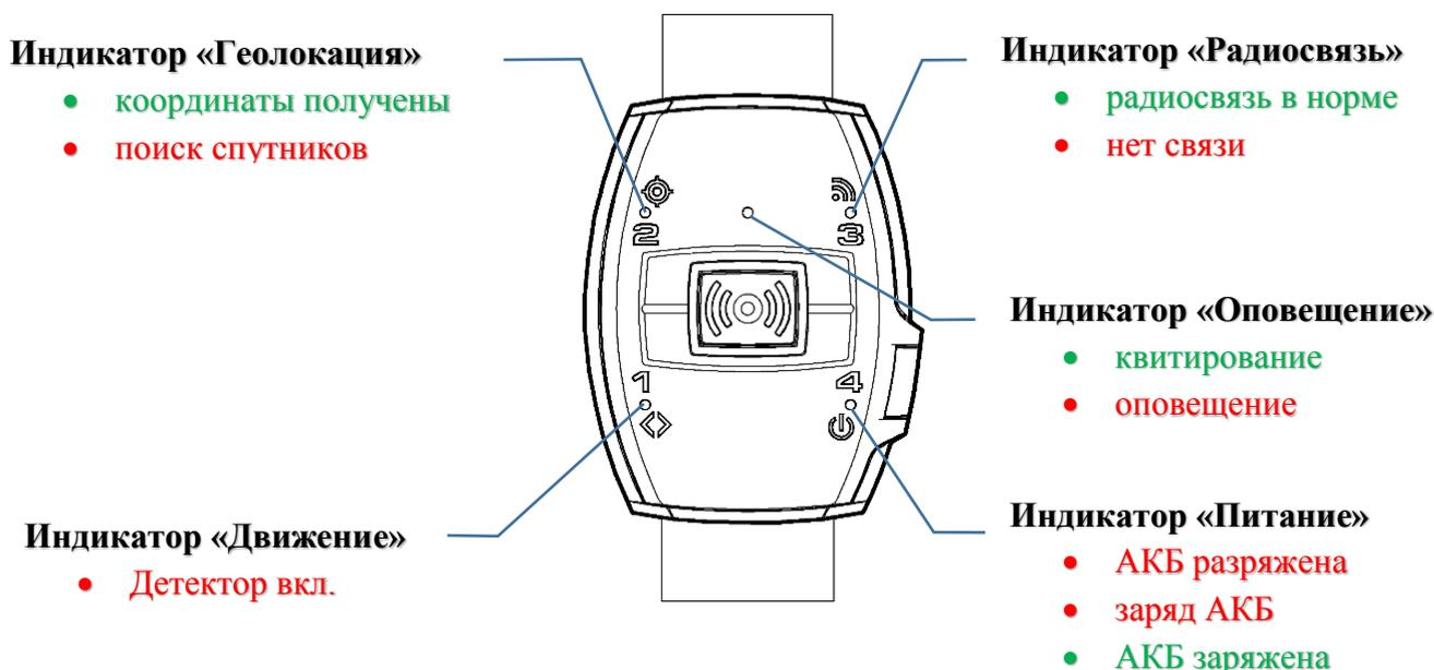
Индикаторы на устройствах с дисплеем включаются только при включенном дисплее.
