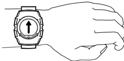
Внимание! Указание направления по стрелке работает только в случае движения браслета. Если вы останавливались, то для определения правильного направления следует опять пройти 10-20 метров в одном направлении.
