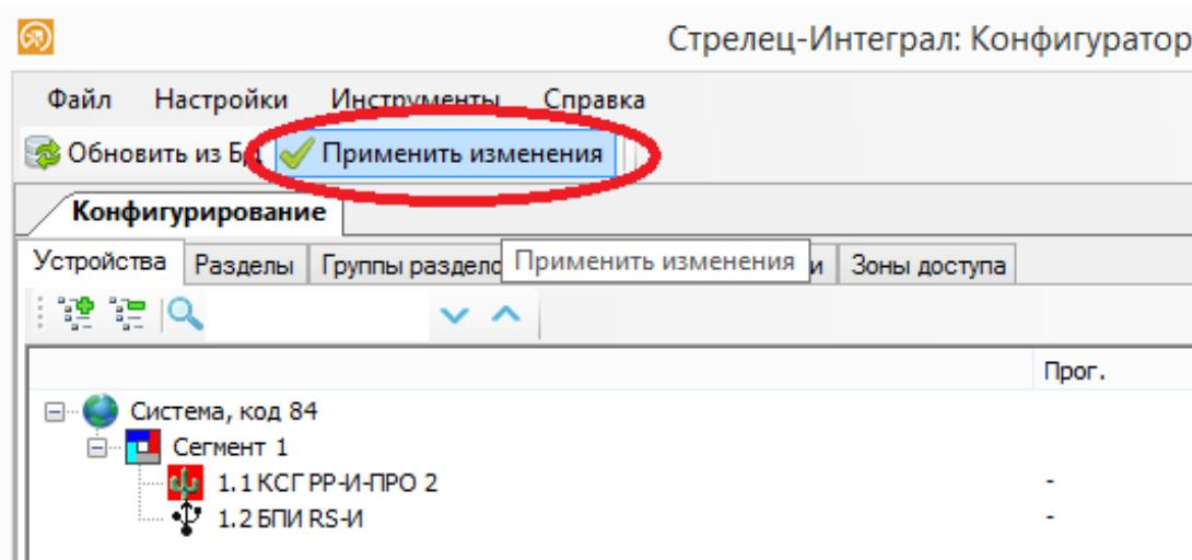
При нажатии этой кнопки выполняется автоматическая запись настроек в приборы. В дальнейшем, при изменениях любых опций устройств, повторной инициализации устройств не требуется, достаточно нажать кнопку "Применить изменения".
