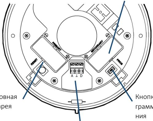
Колодка подключения сигнала для трансляции в реальном времени (вход ГО и ЧС). Замкнуть "D" на землю для начала трансляции, сигнал подавать на "A" (амплитуда – 1В). Длительность трансляции – 1 минута
